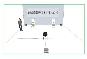
3 台のブラックボックスを設置する場合 1 台目、2 台目をスピーカーの後ろの壁の左右両端に設置し、3 台目をリスニングポイントの後方の壁際に設置します。設置はそれぞれ壁から 1 0cm 以上離して下さい。
