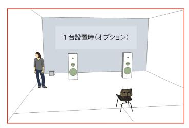
2. スピーカー背後の左右いずれかの壁近くに設置します(横、後ろの壁からそれぞれ 10 cm以上離す)。
