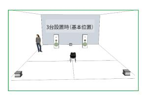
3 台のブラックボックスを設置する場合 1 台目をスピーカー間の中心部に置き、2 台目、3 台面を部屋の後方コーナーに設置します。設置 はそれぞれ壁から 10cm 離して下さい。
