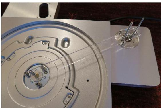
円形サブアームベースの調節完了の後、Reed5A のアームベース部を付属の M5 キャップスクリュー3 本を使って固定します。
